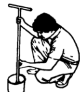
Figura 2. Coloque 5 a 10 muestras in un balde plástico; mezcle, seque y transfiera a la bolsa.
