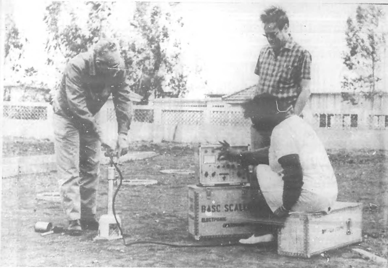
Sonda de neutrones para medir el grado de humedad a diferentes profundidades en el suelo. En la foto los ingenieros: Julia Valdés, Juan Bruno Zayas y el francés Jacques Houssin.
